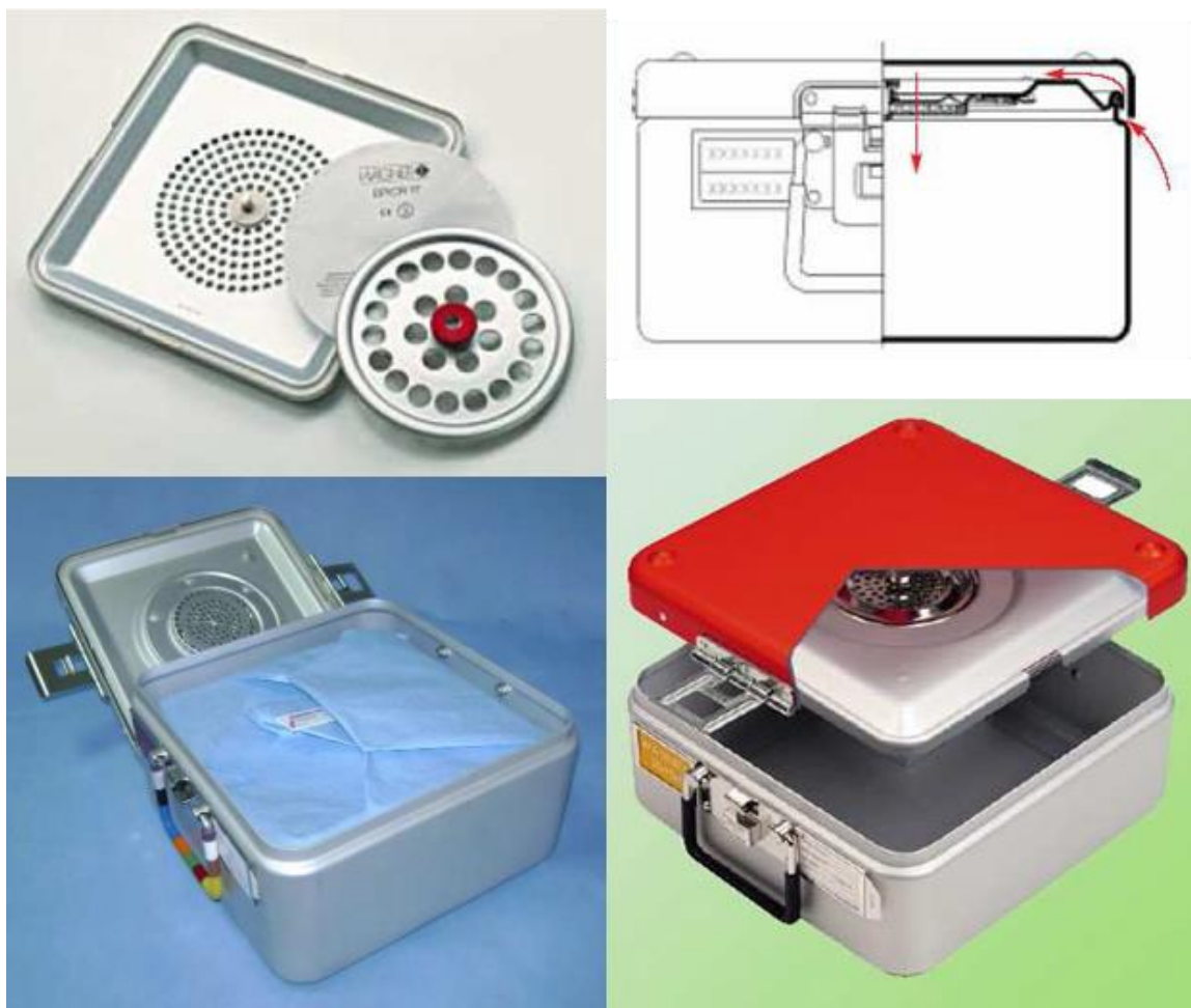
a. Contenedor reutilizable: tapa, filtro y porta filtro. b. Flujo agente esterilizante. c. Contenedor con bandeja listo para el cierre. d. Interior, exterior, tapa. Figura 7. www.amcor.com
