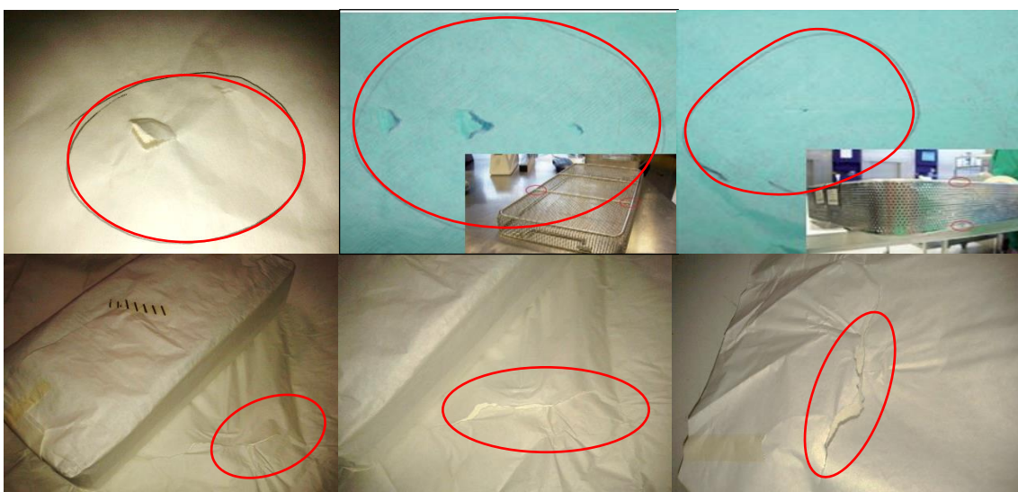
Figura 21 Desgarros, perforaciones, defectos del material y pinholes
